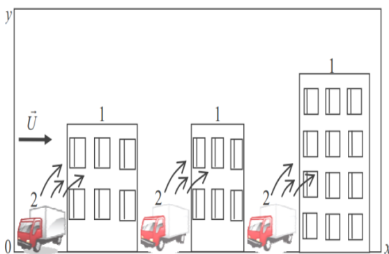
Hình 5. Sơ đồ khu vực tính toán 1 – tòa nhà; 2 – nơi phát thải chất ô nhiễm
